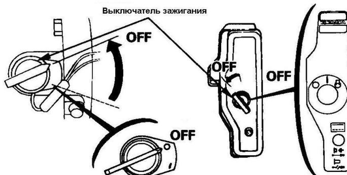
Рисунок 11 – Выключатель зажигания в положении "OFF" ("Выключено")
