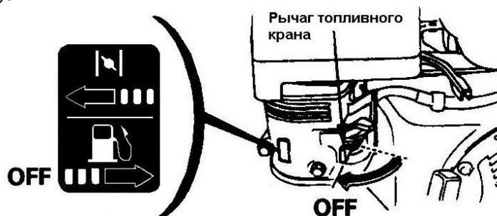
Рисунок 12 – Рычаг топливного крана в положении "OFF" ("Выключено")
