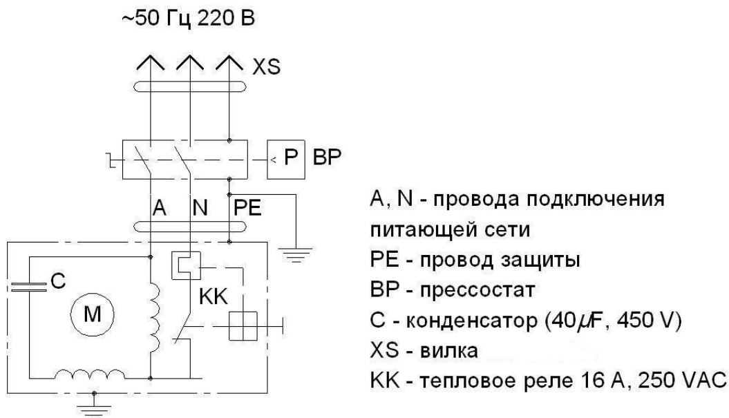
Рисунок А.2 - Схема электрическая принципиальная компрессоров СБ4/С-20.J2047В, СБ4/С-50.J2047В, СБ4/С-100.J2047В, СБ4/С-100.J2047ВВ
