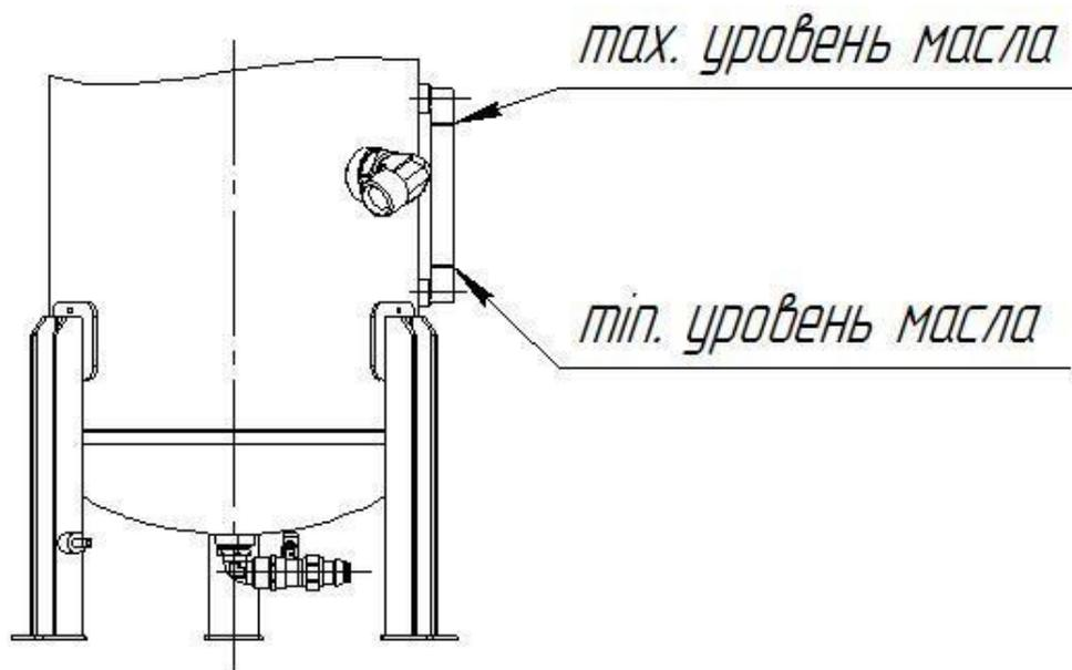
Примечание: Оптимальная температура окружающей среды для контроля граничных значений (max и min) уровня масла равна  $20 \pm 5^\circ\text{C}$ .
