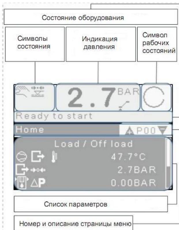
Рис. 1. Дисплей контроллера
