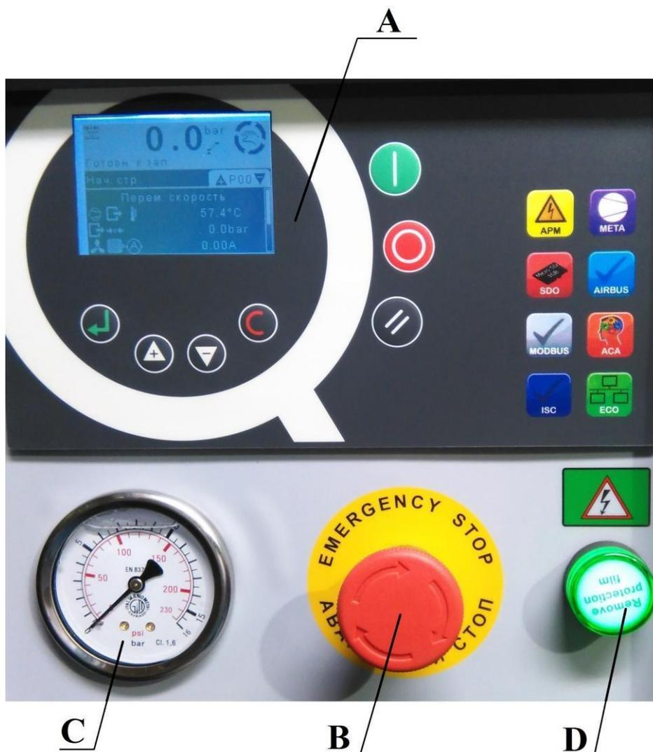
**А** - электронный контроллер предназначен для управления и контроля работы компрессорной установки (см. руководство пользователя контроллера).
