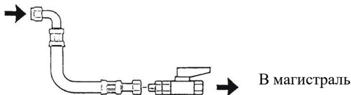
Трубопроводы следует укладывать с уклоном 0,005 в сторону линейных влагоотделителей.
