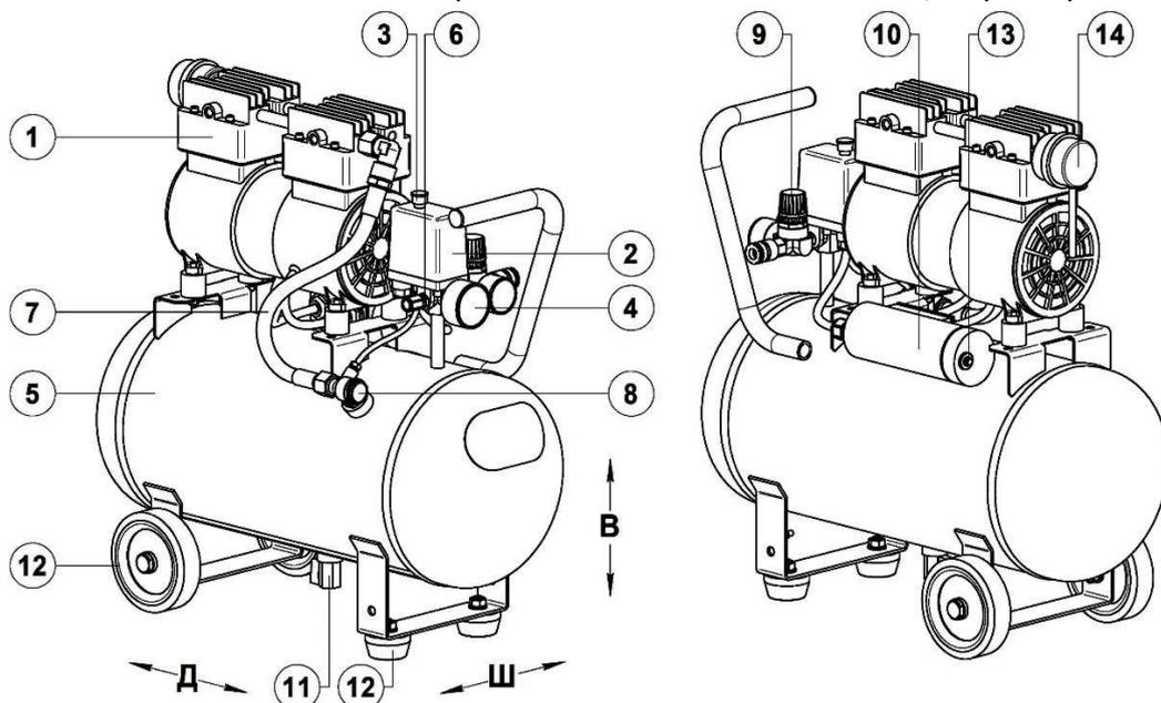
Рисунок 7 - Общий вид компрессора СБ4/С-24.OLD10
