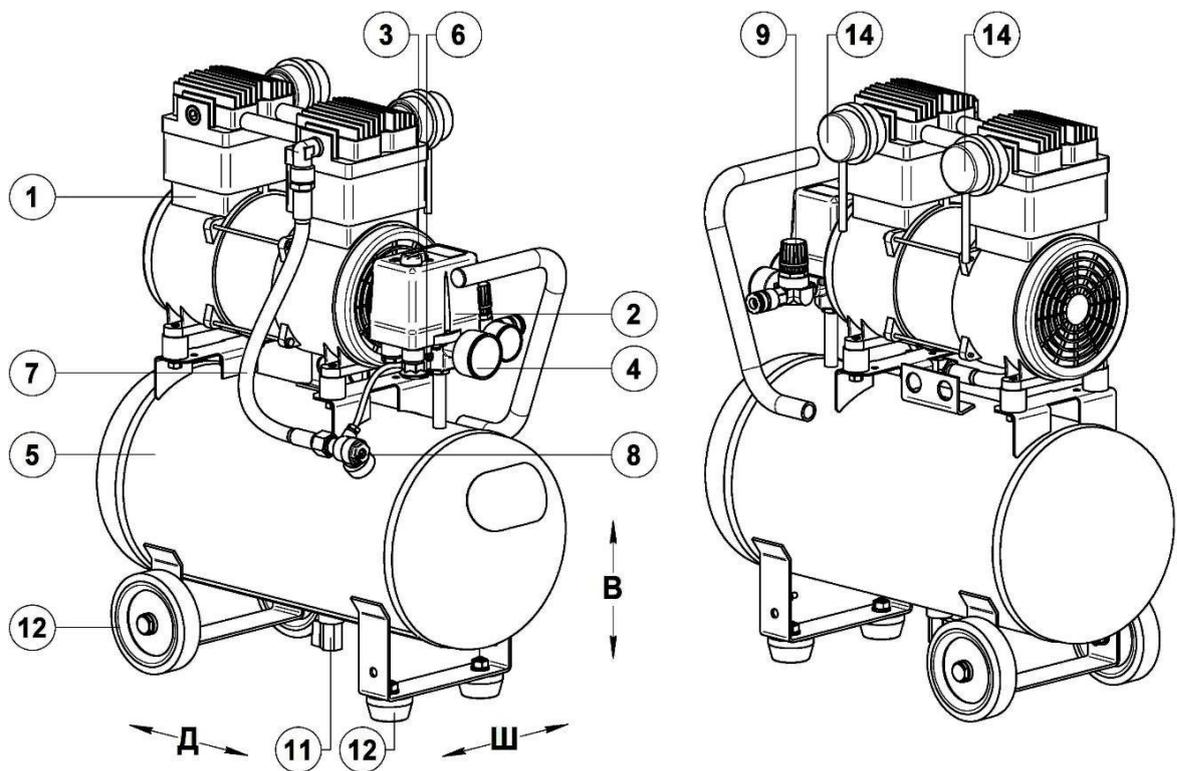
Рисунок 9 - Общий вид компрессора СБ4/С-24.OLD20-3, СБ4/С-50.OLD20-3
